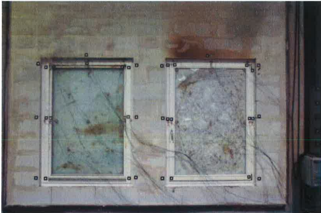
Abbildung 9: Zustand der Probekörper in der 32. Versuchsminute.
