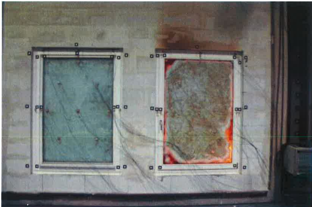
Abbildung 5: Zustand der Probekörper in der 12. Versuchsminute.
